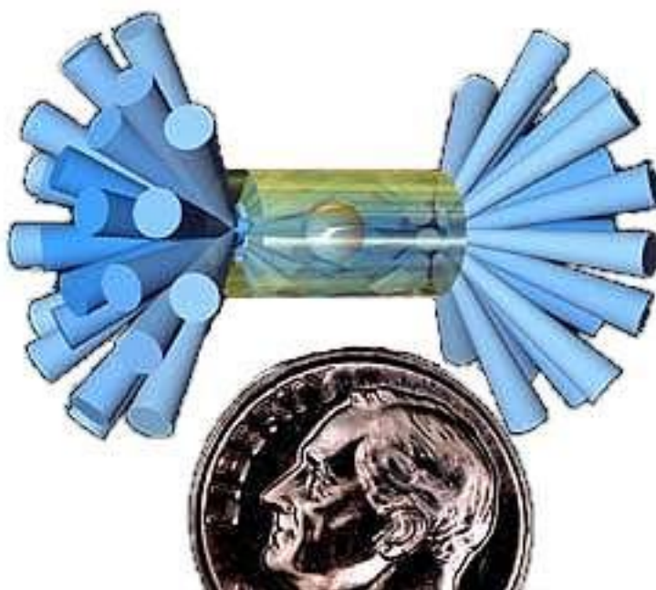
Рис. 7. Схема дії установки з непрямым збудженням термоядерної реакції. Внизу показана 10-ценова монета США [13].
